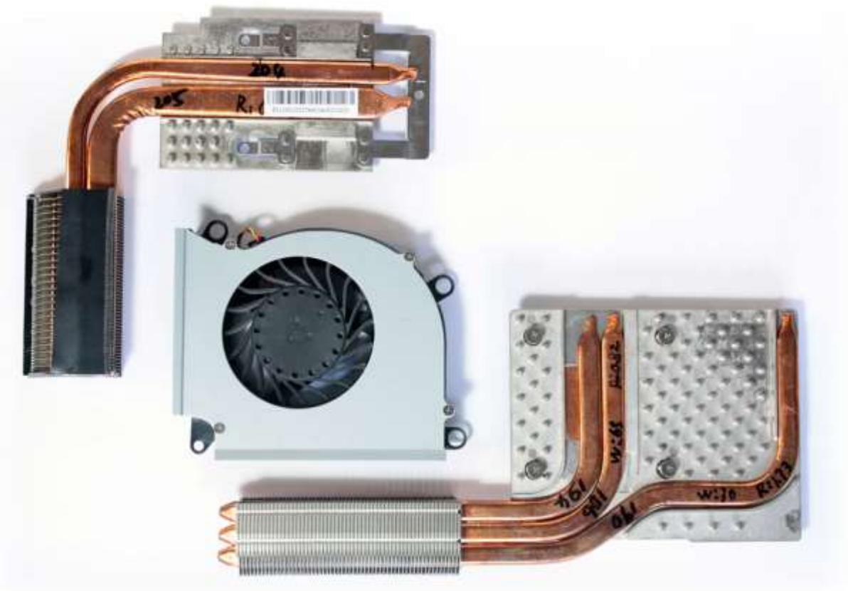
Figura 191: Vista esplosa del kit di raffreddamento con heat pipe
