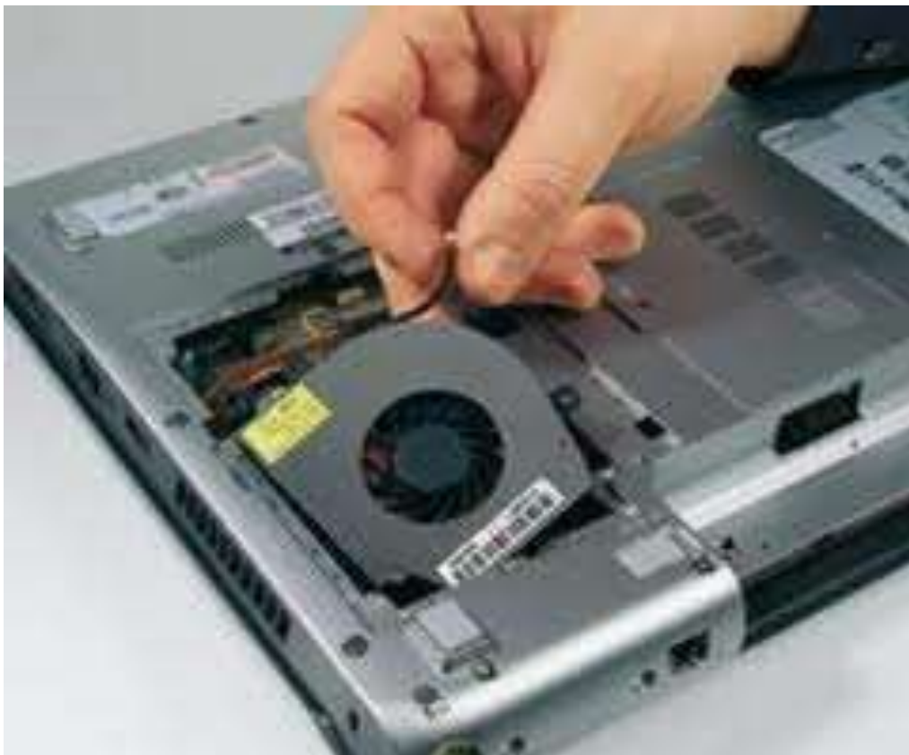
Figura 190: Inserimento di un heat pipe in un computer portatile
