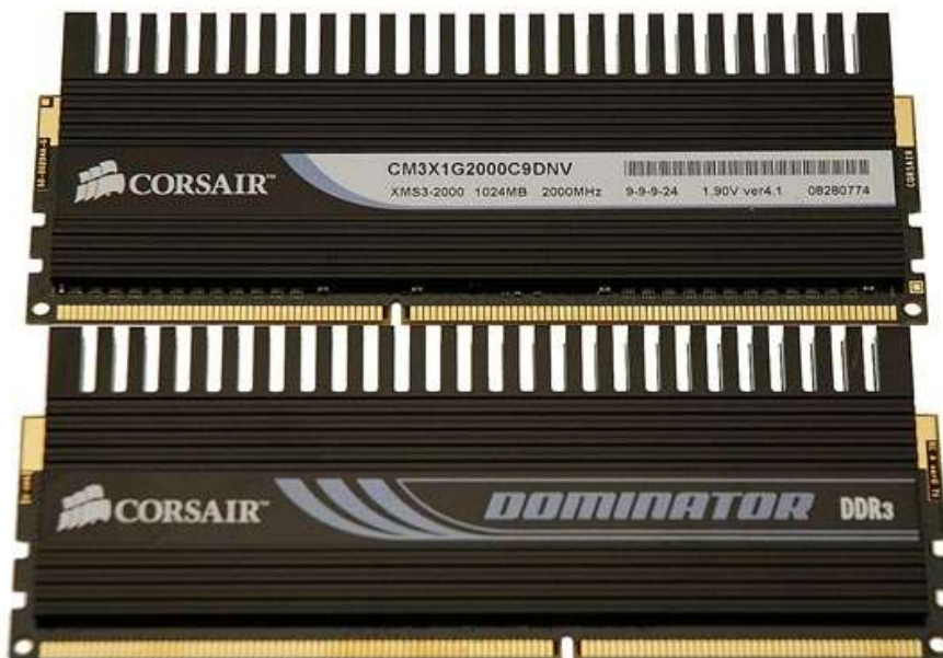
Figura 51: Esempio di memorie RAM con alette di raffreddamento
