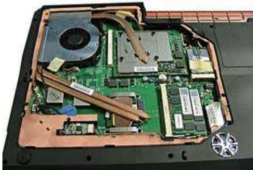
Figura 189: Inserimento di un heat pipe per computer portatili
