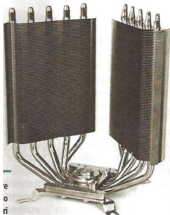
Figura 188: Sistema di raffreddamento con heat pipe a due radiatori
