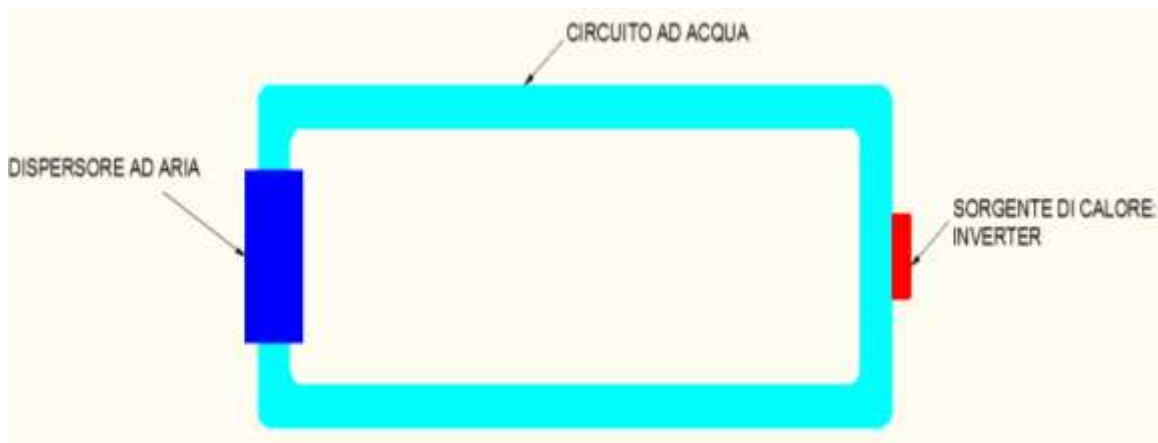
Figura 200: Circuito di raffreddamento a circolazione naturale
