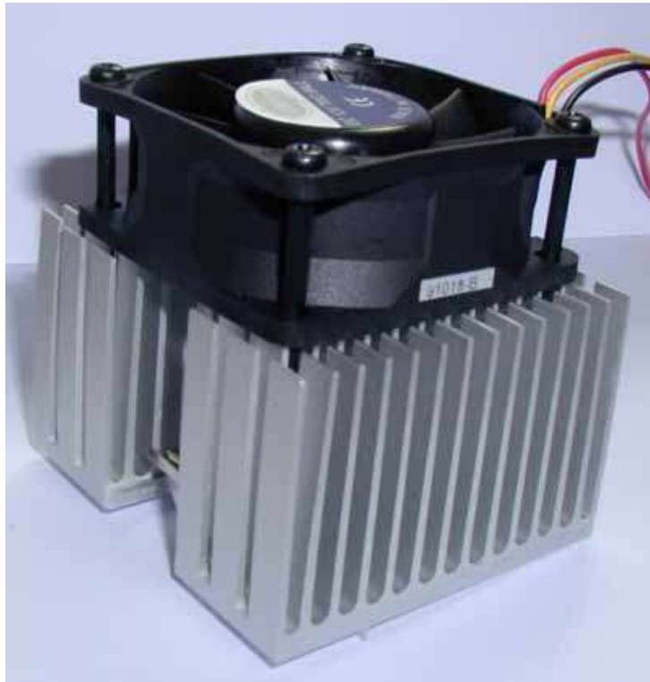
Figura 50: Sistema di raffreddamento con alette e ventola
