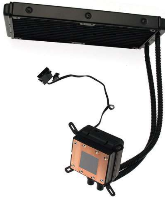
Figura 75: Circuito di raffreddamento a liquido di un processore
