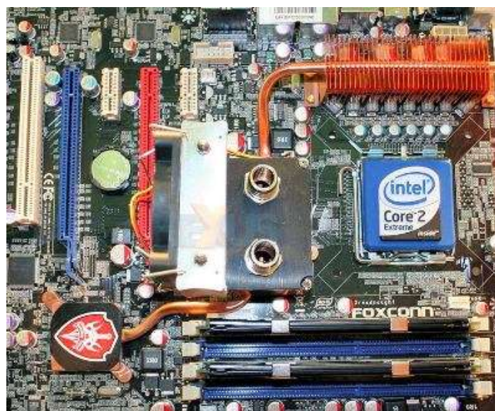
Figura 176: Applicazione del raffreddamento a liquido su una motherboard
