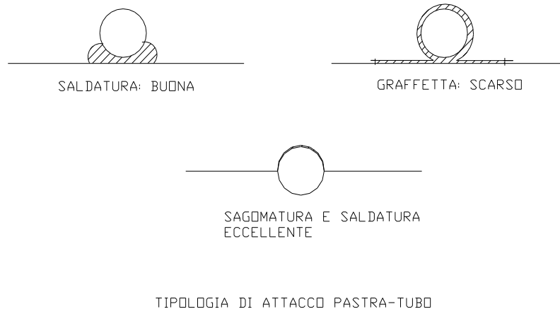
Figura 81: Tipologie di attacco dei tubi alla piastra captatrice
