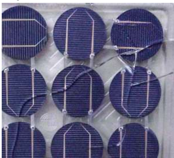
Figura 129: Particolare dell'array di celle fotovoltaiche
