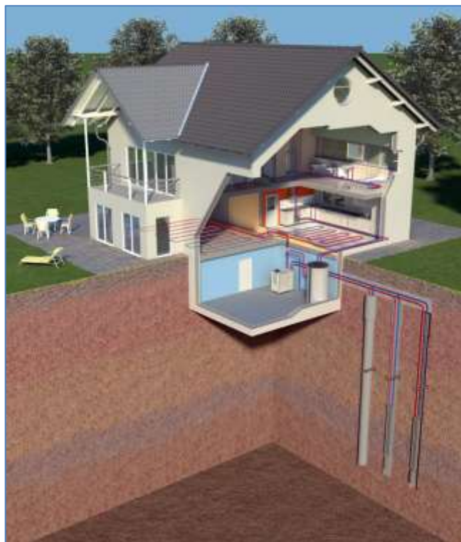
Figura 243: Applicazione sonde SGV ad un edificio
