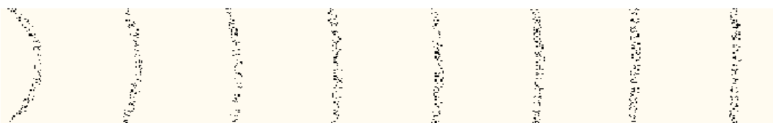
Figura 257: Esempio di propagazione di onde acustiche: inizialmente sferiche e poi piane a grandi distanze
