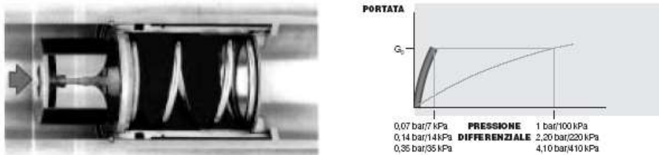
Figura 84: Curva \Delta p -G per un Autoflow sotto il campo di lavoro
