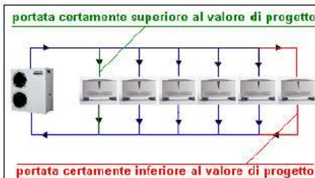
Figura 118: Esempio di rete a ritorno diretto con equilibratura dei circuiti
