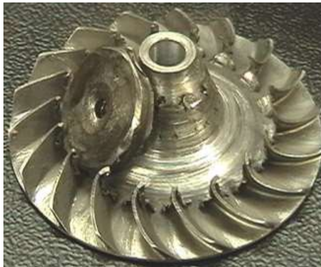
Figura 219: Vista dell'impeller del Turbocor®
