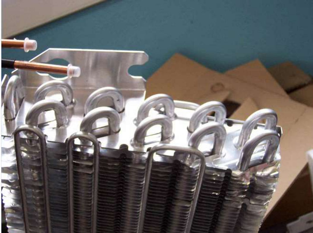
Figura 281: Esempio di batteria alettata
