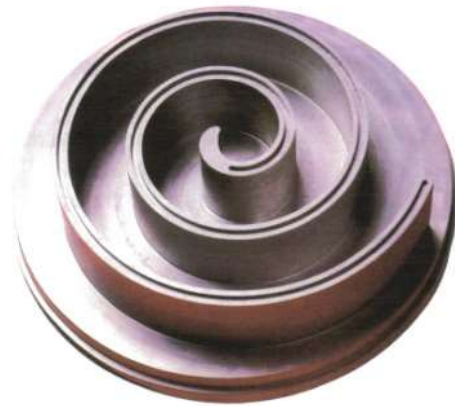
Figura 228: Vista di una spirale orbitante di uno scroll
