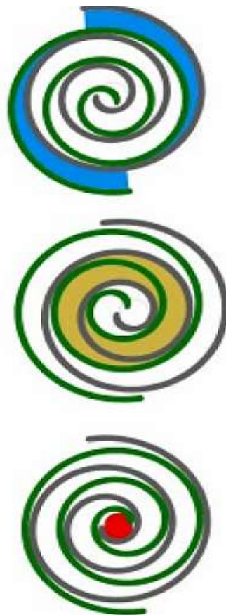
Figura 231: Fasi principali di uno scroll
