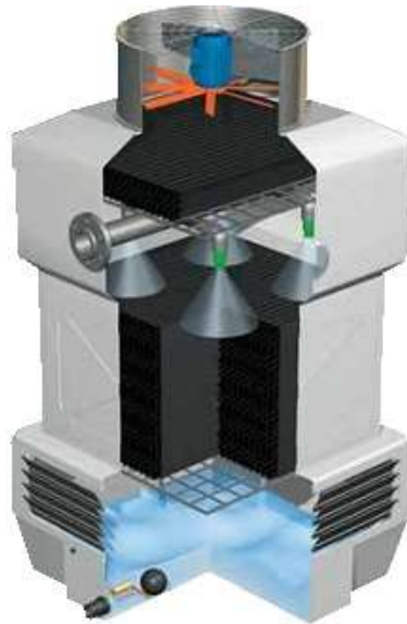
Figura 251: Torre di raffreddamento commerciale
