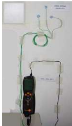
Figura 180: Posizionamento delle sonde a contatto
