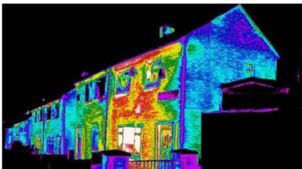
Figura 177: Esempio di verifica di isolamento con termografia
