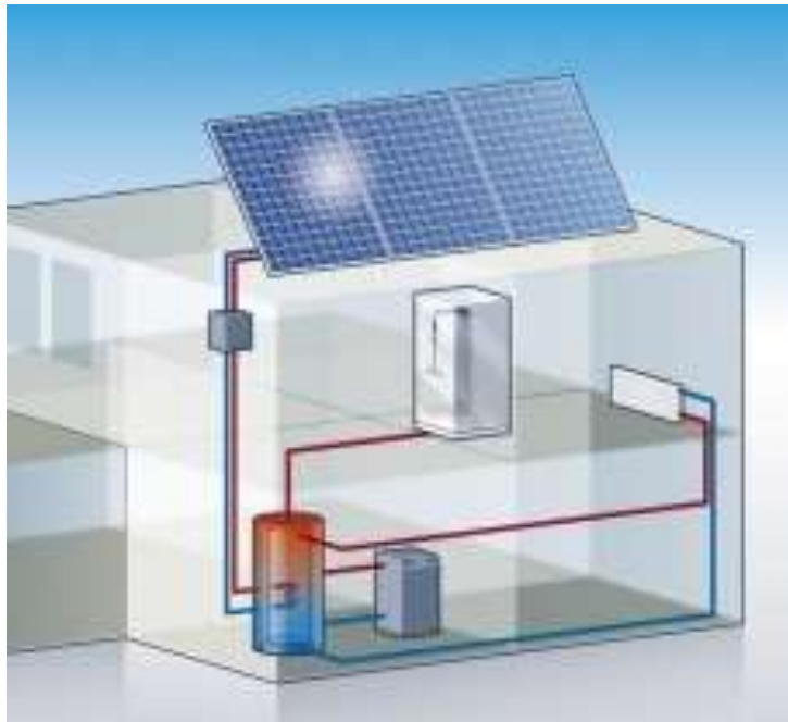
Figura 199: Impianto con pompa di calore ed energia solare
