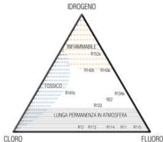
Figura 211: Qualità dei componenti dei fluidi termovettori.
