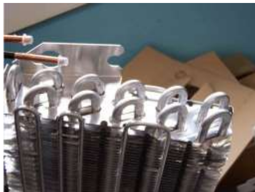
Figura 308: Esempio di batteria alettata
