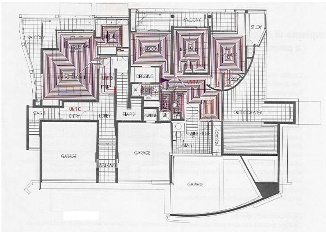
Figura 262: Esempio di impianti radianti in appartamenti
