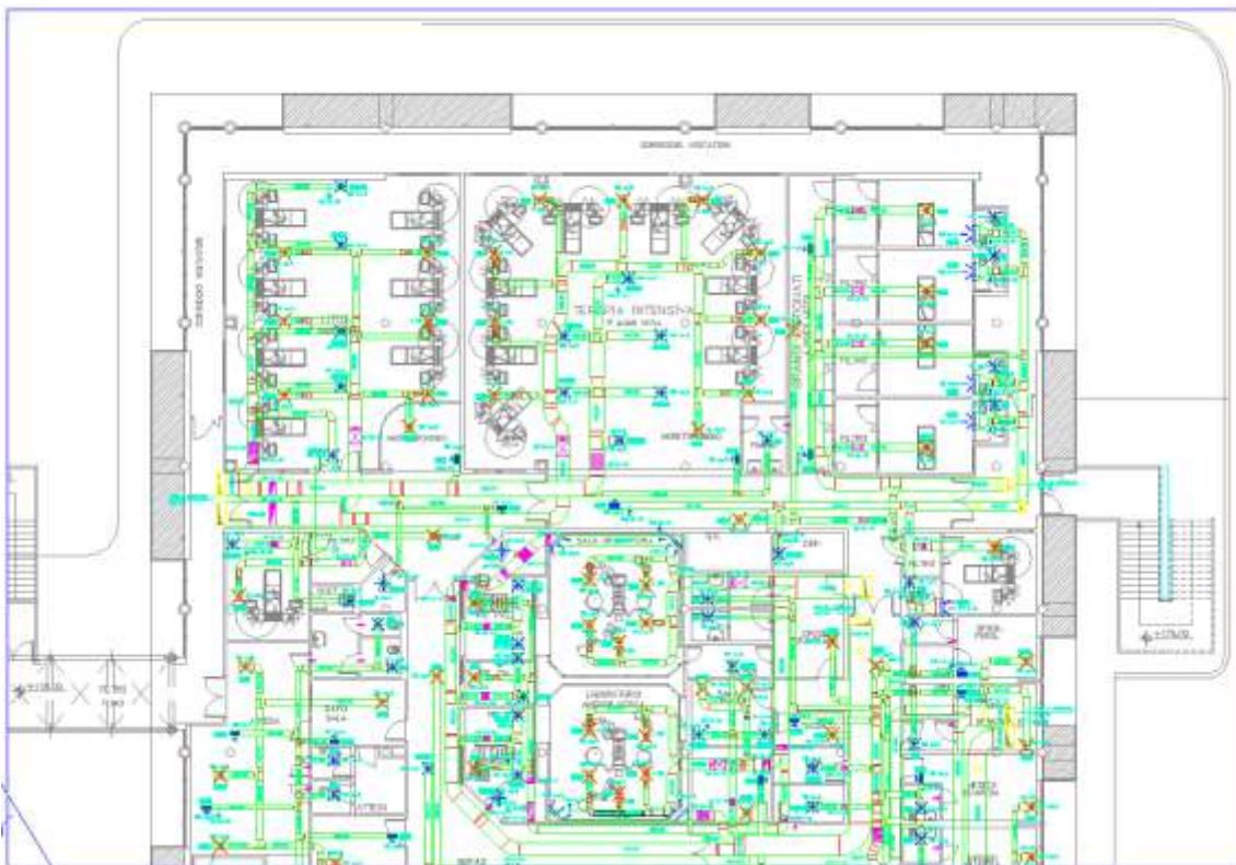
Figura 51: Esempio di rete di distribuzione dell'aria dimensionata
