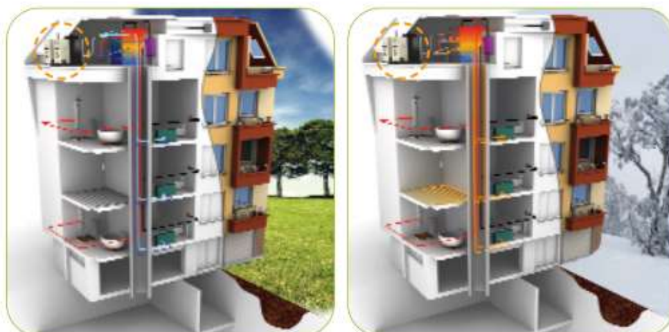
Figura 208: Esempi di installazione di una pompa di calore a gas
