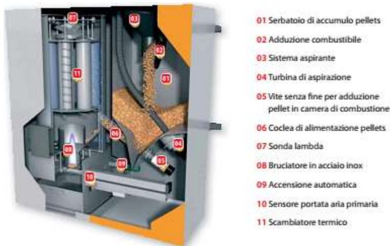
Figura 83: Funzionamento di una caldaia a pellets
