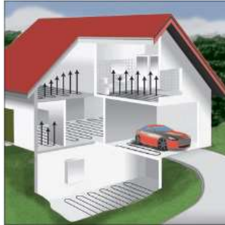
Figura 258: Sistemi a pannelli radianti
