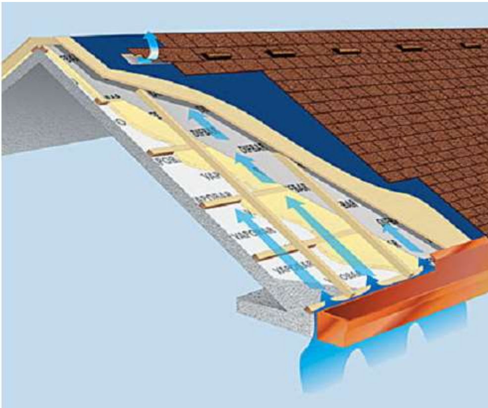
Figura 104: Copertura a falda ventilata
