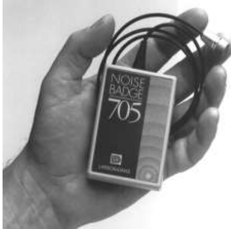
Figura 95: Dosimetro personale per il rumore
