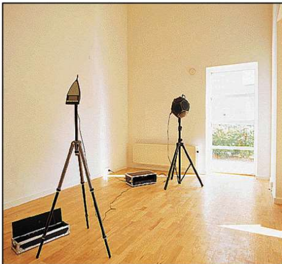
Figura 119: Posizionamento della sorgente sonora e del fonometro
